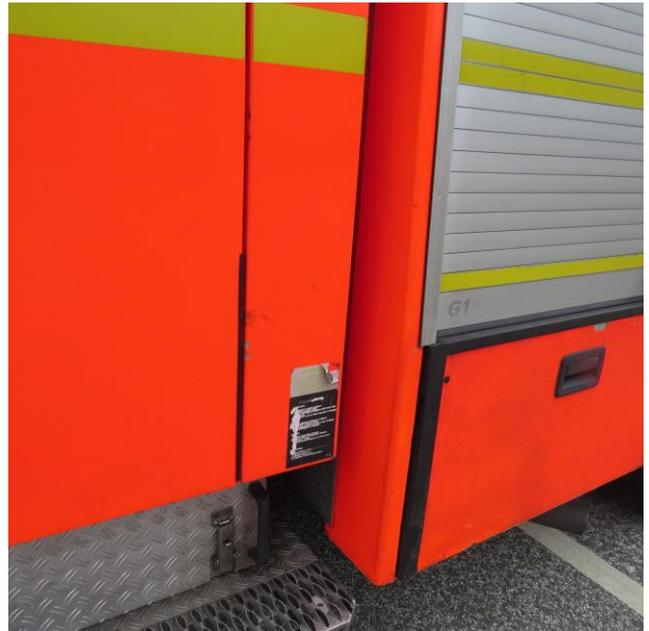
**Kabine links hinten Lackbeschädigungen**
