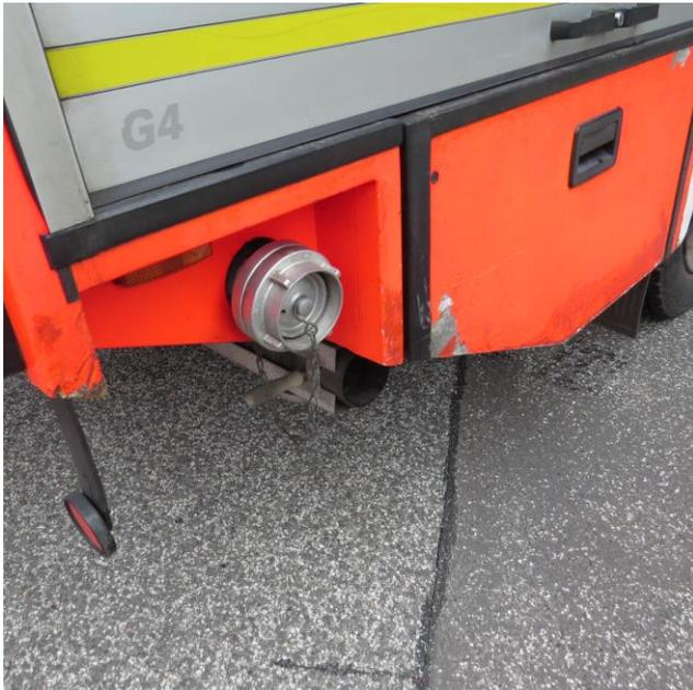
**Aufbau hinten rechts Lackbeschädigungen**
