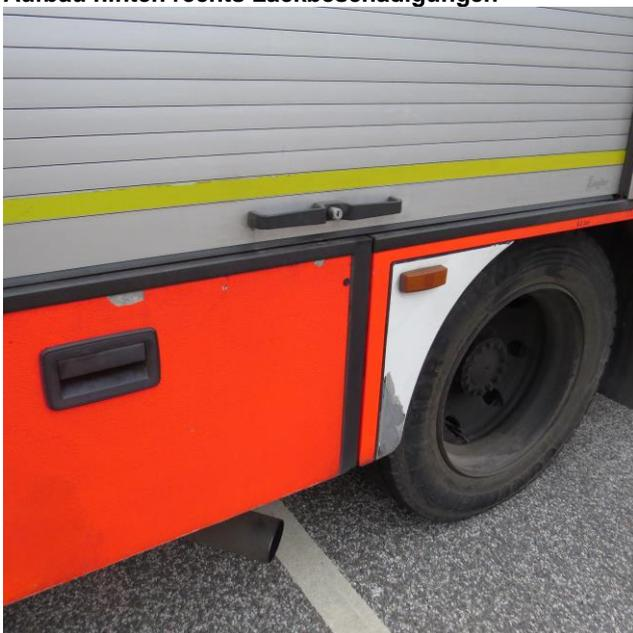
**Ansicht Aufbau links unten, Lackbeschädigungen**
