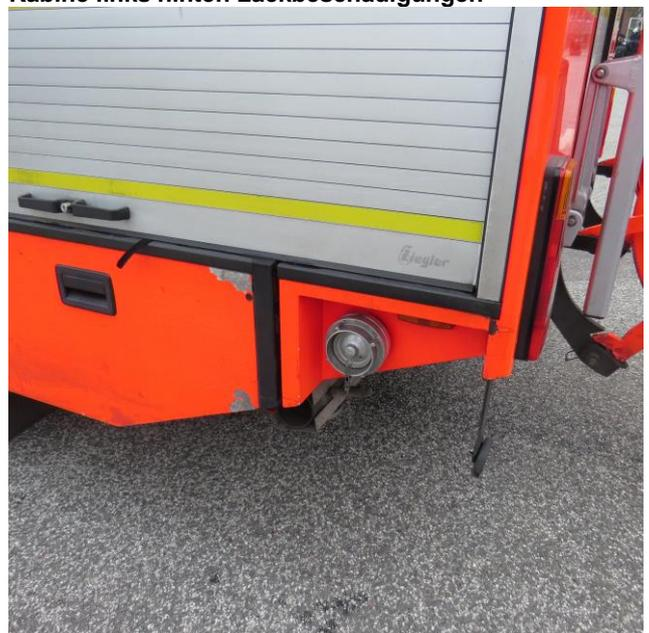
**Ansicht hinten links, Lackbeschädigungen**
