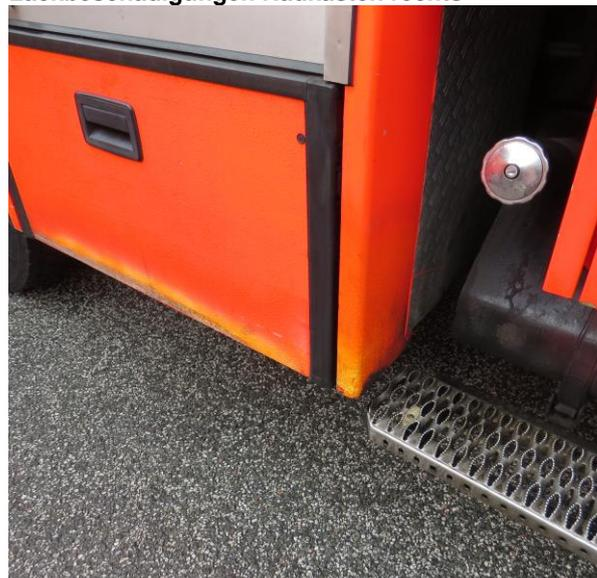
**Staukasten rechts, Lackbeschädigungen, leicht eingedrückt**
