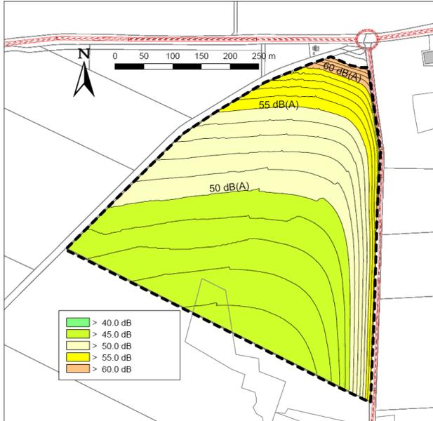
Abbildung 14: maßgeblicher Außenlärmpegel für schutzbedürftige Räume, Quelle: Schalltechnische Untersuchung, Abbildung 3, LairmConsult GmbH
