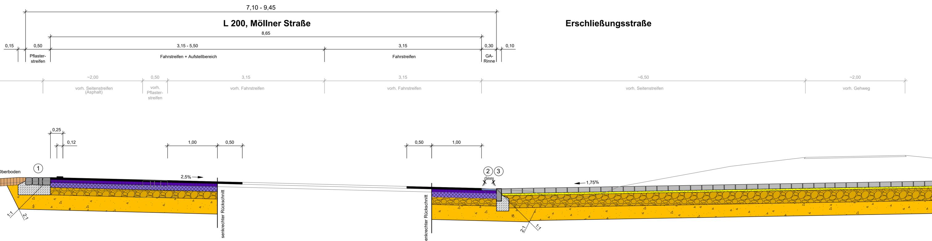
① Pflasterstreifen aus vorh. Pflastersteinen, bzw. unter Zulieferung von neuen Steinen auf 20 cm Betonbettung und 15 cm Betonrückenstütze C 16/20 gem. DIN 18318
