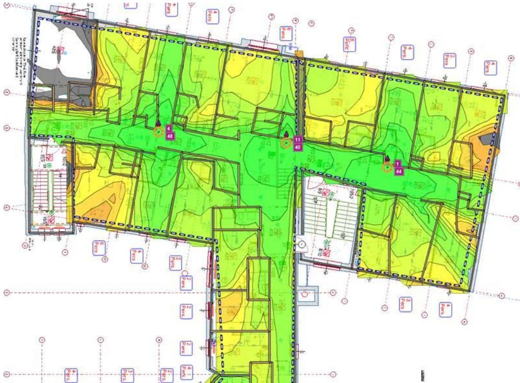
Abb. 4: WLAN-Funkausleuchtung (Beispiel)
