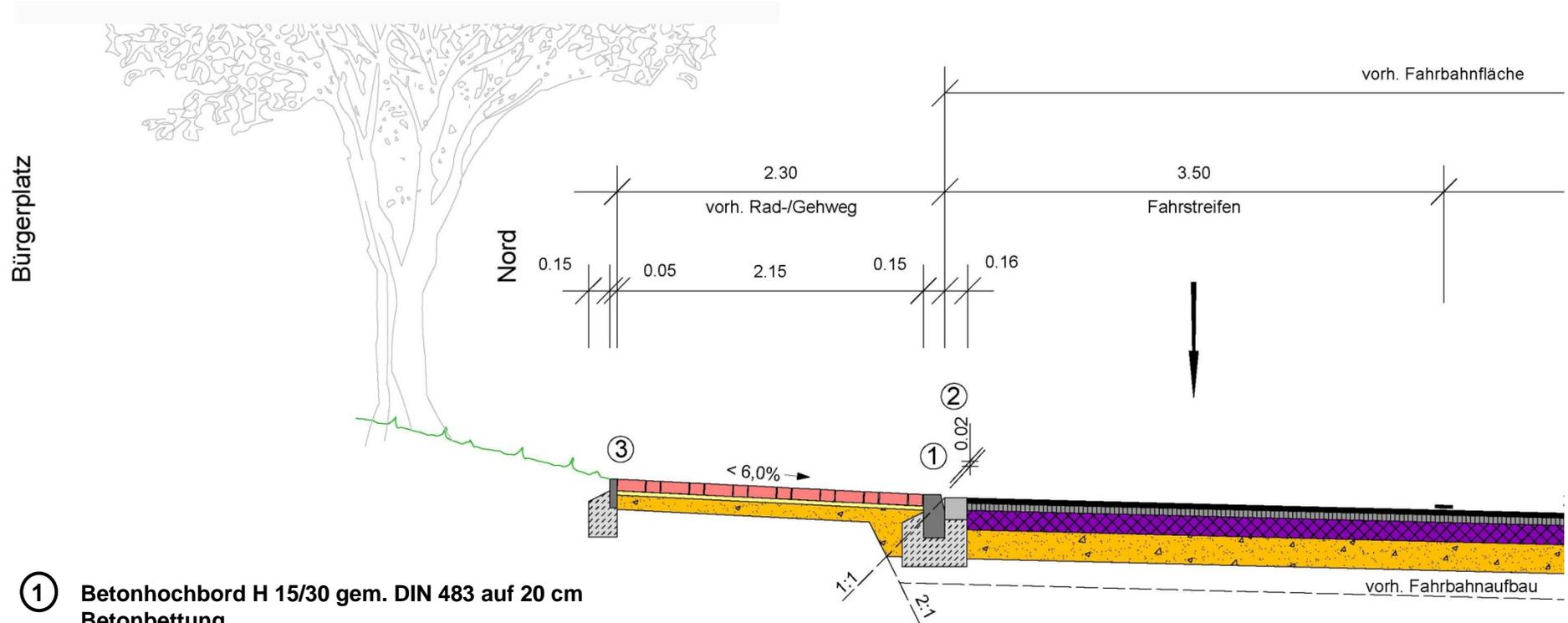
① Betonhochbord H 15/30 gem. DIN 483 auf 20 cm Betonbettung und 15 cm Betonrückenstütze C16/20
