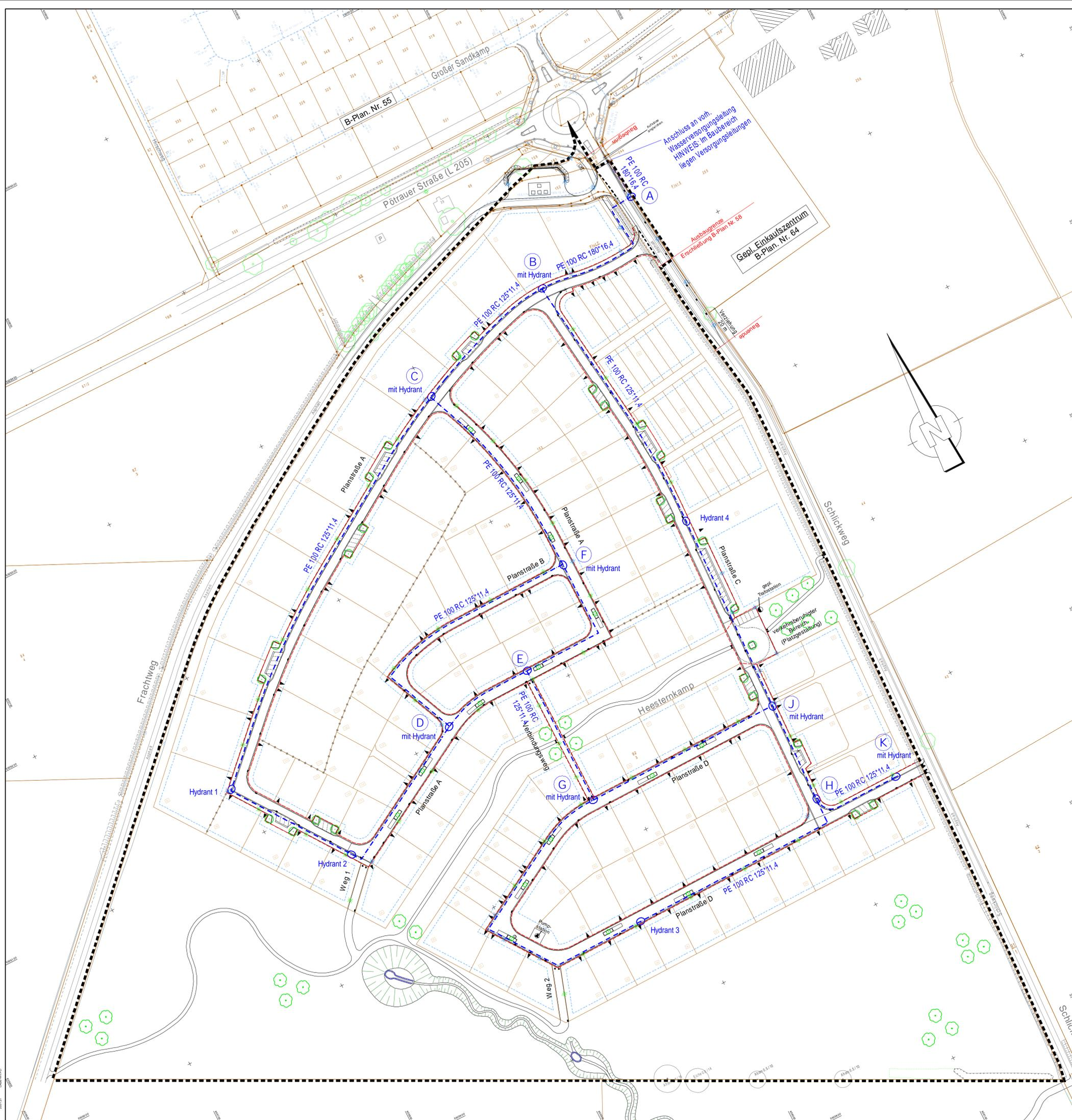
Die Grundstücksanschlüsseleitungen der Trinkwasserversorgung werden im Bereich der Hausanschlüsseleitungen für Schmutz- und Regenwasser bis 1,00 m auf die Grundstücke vorgestreckt !
