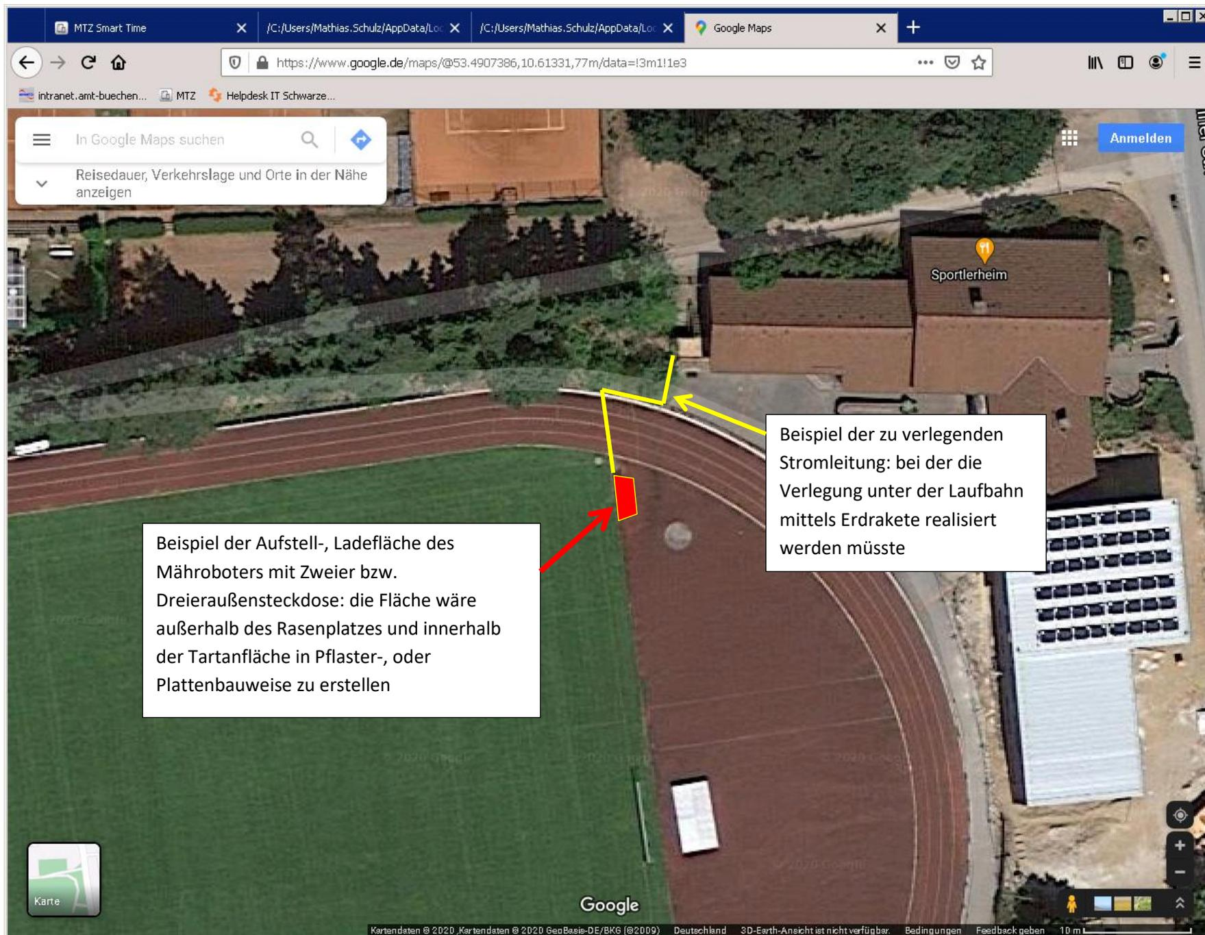
Beispiel der Aufstell-, Ladefläche des Mähroboters mit Zweier bzw. Dreieraußensteckdose: die Fläche wäre außerhalb des Rasenplatzes und innerhalb der Tartanfläche in Pflaster-, oder Plattenbauweise zu erstellen
