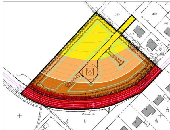
Abbildung 8: Anlage 7 Verkehrslärmgutachten, Lärmkarte Höhe 5,6 m, Quelle: ibs
