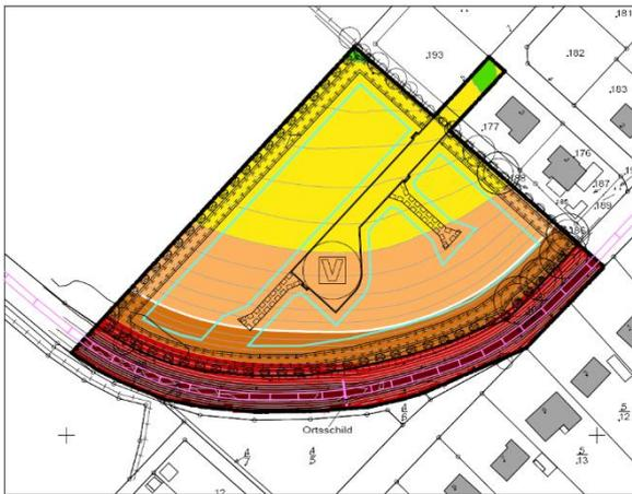
Abbildung 7: Anlage 6 Verkehrslärmgutachten, Lärmkarte 2,0 m Höhe, Quelle: ibs
