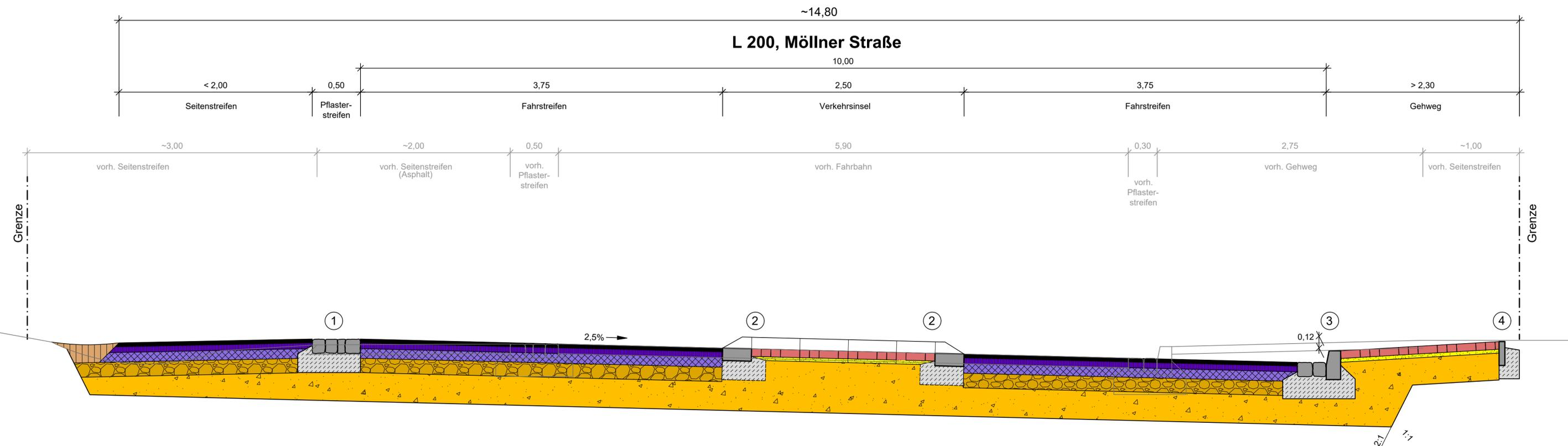
① Pflasterstreifen aus vorh. Pflastersteinen, bzw. unter Zulieferung von neuen Steinen auf 20 cm Betonbettung und 15 cm Betonrückenstütze C 16/20 gem. DIN 18318
