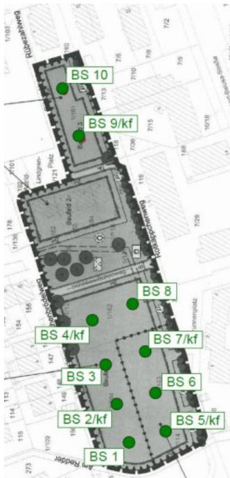
Abbildung 12 - Baugrunduntersuchung mit Bohrpunkten
