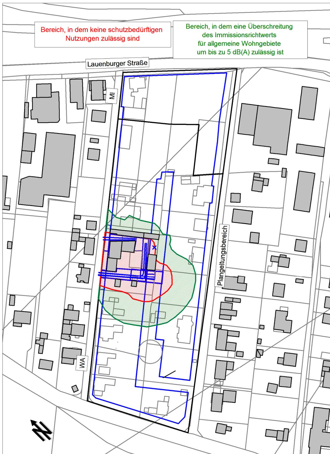
Alternativ besteht als aktive Lärmschutzmaßnahme die Möglichkeit auf dem Betriebsgrundstück des Brennstoffhandels Container mit einer Höhe von 3 m und einer Länge von mindestens 16 m aufzustellen. Die Ergebnisse für die freie Schallausbreitung sind in Form von Rasterkarten für das Erdgeschoss (Aufpunkthöhe 2,5 m), das 1. Obergeschoss (Aufpunkthöhe 5,3 m) sowie das 2. Obergeschoss (Aufpunkthöhe 8,1 m) in Anlage A 3.2 dargestellt.
