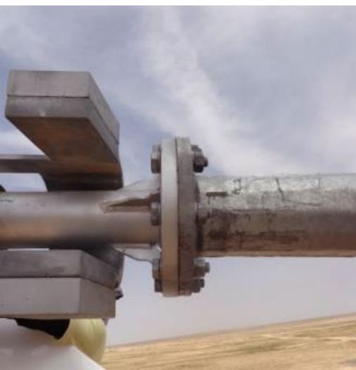
Abbildung 4: Maschinengondel mit dem liegenden Mast verschraubt.
