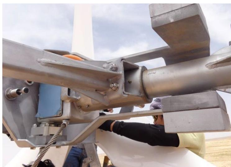
Abbildung 5: Mit dem Maschinenträger verschraubten Rohr zur Windfahne. Die 4 Stück Schrauben M12 werden mit 50 Nm angezogen.
