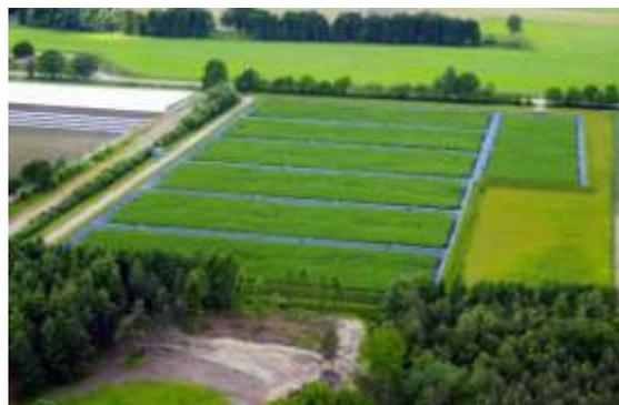
Klärschlammvererdungsanlage der Stadtwerke Meppen
