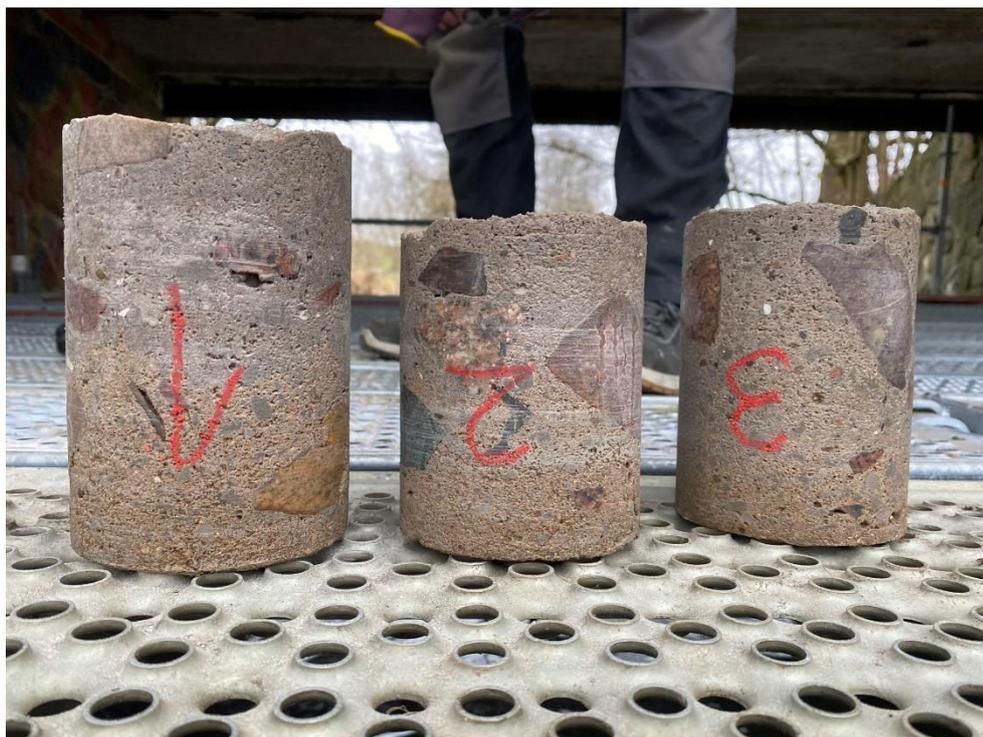
Abbildung 7 Entnommene Bohrkern aus der Brückenplatte
